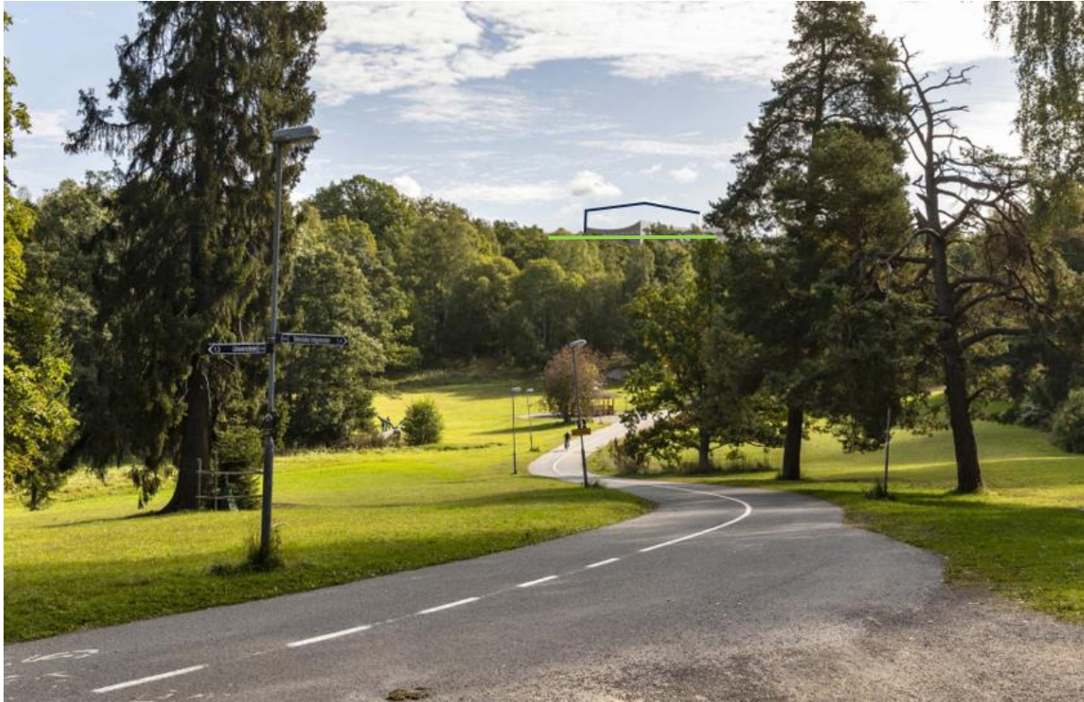
Figur 21. Vattenreservoaren sticker upp som mest ca 3-4 m över trädtopparna (se höjd hos fasad kring krenelering i Figur 7, trädens medellinje enligt grön linje) men beräkning visar av 18 m av fasadhöjden ska synas, ungefär enligt den svarta konturlinjen. Bildkälla: Wingårdhs samt egen komplettering.
